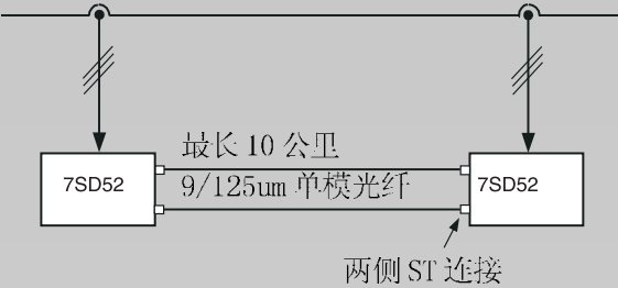
图 9 最长 10 公里的光纤直连
